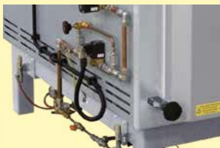
Gasstrækning og termoelement på kammerovnovn
