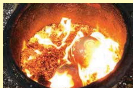
Afkøling og neddykning af varen i løv, halm eller spåner
