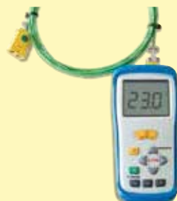
Temperaturmåler til RAKU ovn 100
