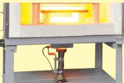
Propangasbrænder med 15 kW, monteret under ovnen
